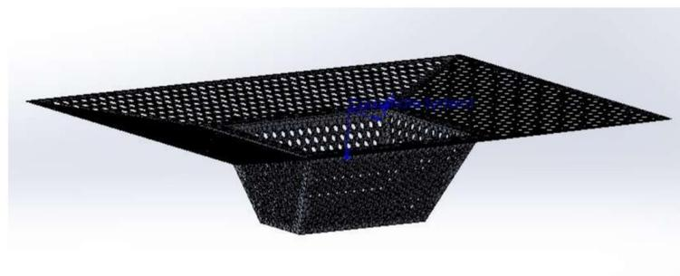
Figura II.4. Diseño conceptual de filtro para imbornales. Fuente: TFM Marco Solaro Menendez.
